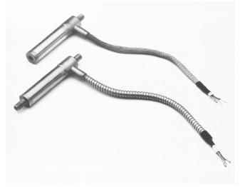
Hohlpatronen finden breite Anwendungsmöglichkeiten zur Erwärmung fliessender Medien. Die zu temperierenden Stoffe werden durch ein im Zentrum geführtes Innenrohr geleitet. Die Heizwicklung wird mit geringer Distanz um diese Leitung gelegt und gewährleistet so besten Wirkungsgrad. Zusätzliche Isolierung des Aussenmantels kann das Resultat in besonderen Fällen noch verbessern.
